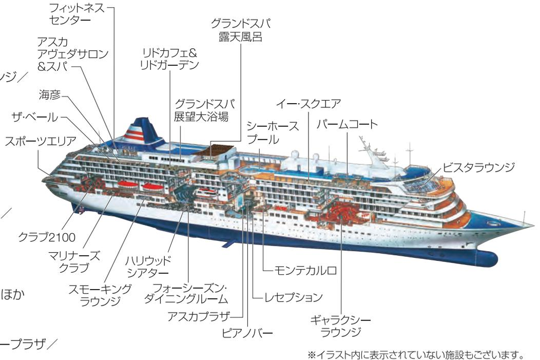
■船籍/日本 ■全長/241m ■全幅/29.6m ■総トン数/50,444トン ■喫水/7.8m ■航海速度/最高21ノット ■横揺れ防止装置/フィンスタビライザー ■客室数/436室(全室海側)
